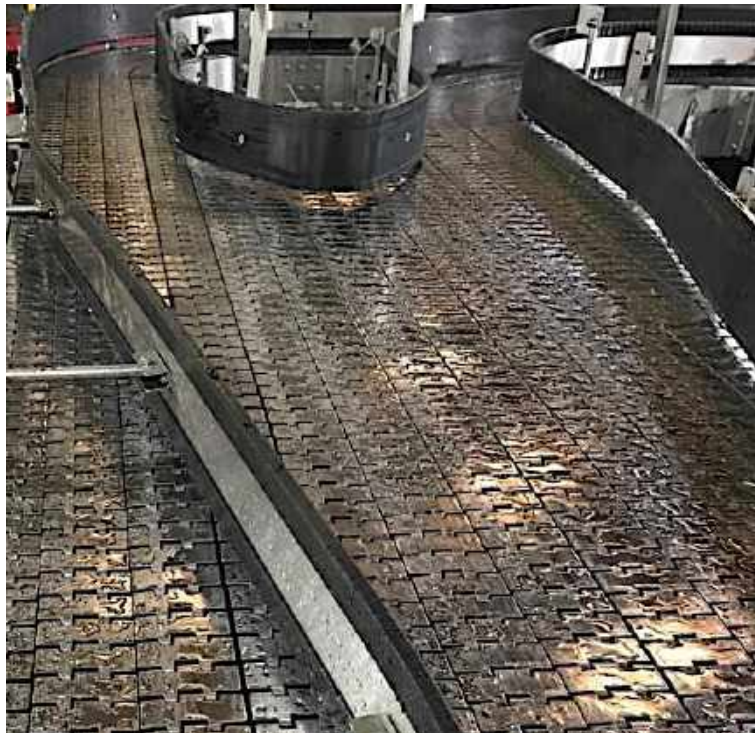
Figura 14 - Transportador de correntes metálicas operando em paralelo
