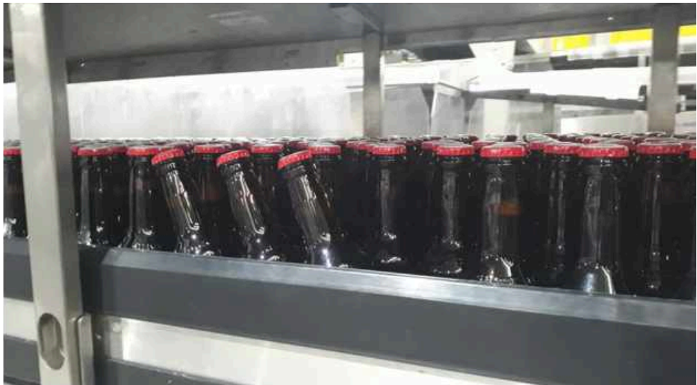
Figura 31 - Problema de garrafas tombando nos perfis laterais
