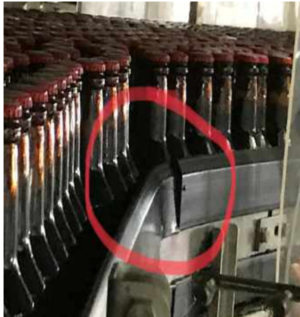
Figura 34 - Perfil lateral com falha na emenda
